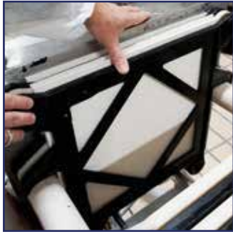
Fase 3 Introducir la tercera placa en el sentido opuesto respecto a la placa introducida anteriormente.
