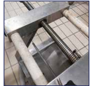
Fase 9 Cerrar el paquete filtrante sin comprimir completamente las placas.
