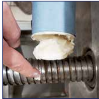
Fase 8 Engrasar el tornillo sinfín (actividad a realizar periódicamente).
