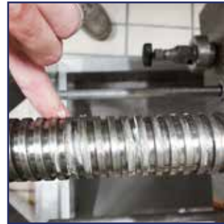
Fase 8 Engrasar el tornillo sinfín (actividad a realizar periódicamente).
