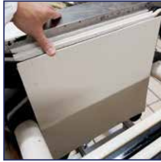
Fase 4 Introducir la cuarta placa en el sentido opuesto respecto a la placa introducida anteriormente.
