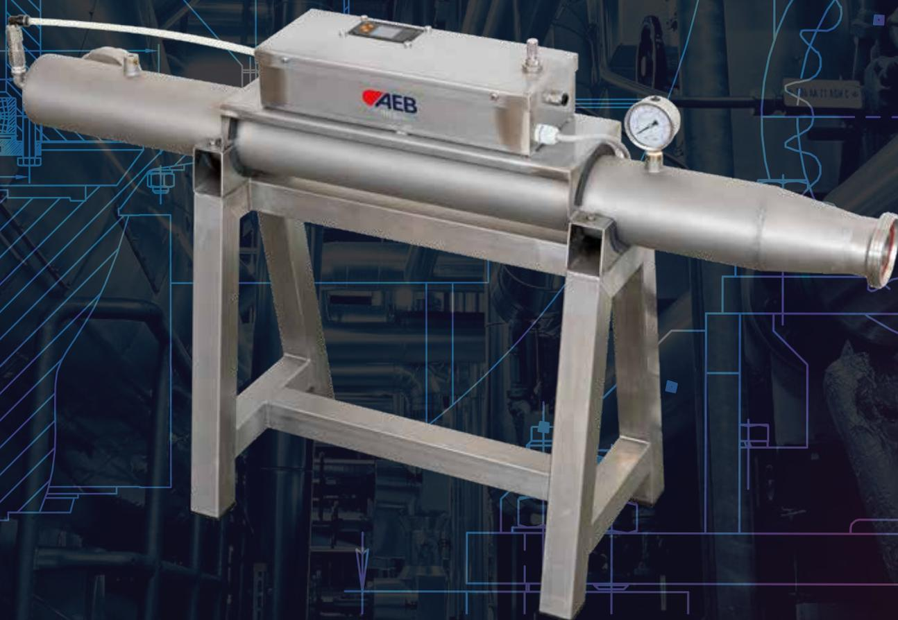
Sistema che permette di eliminare in passaggio l'ossigeno presente in mosti e vini. L'azione di strippaggio avviene iniettando un gas inerte (azoto o anidride carbonica) nel mosto/vino che passando attraverso la porosità di un diffusore in acciaio inox sinterizzato viene micronizzato facilitando l'eliminazione delle particelle di ossigeno.
