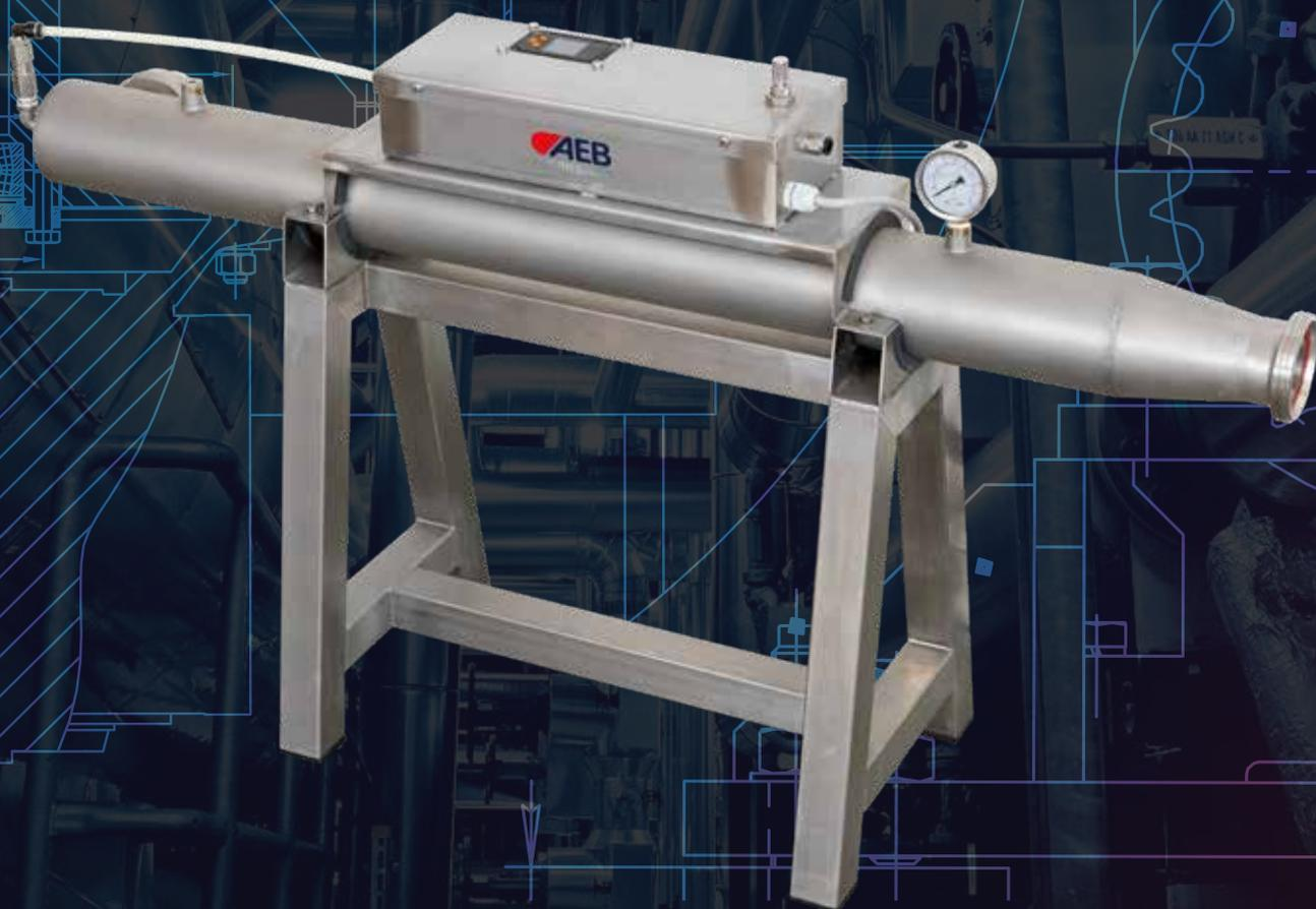
Sistema que permite eliminar en línea, el oxígeno presente en mostos y vinos. La acción de stripping se realiza inyectando un gas inerte (nitrógeno o dióxido de carbono) en el mosto/vino que, al pasar a través de la porosidad de un difusor de acero inoxidable sinterizado, se microniza facilitando la eliminación de las partículas de oxígeno.
