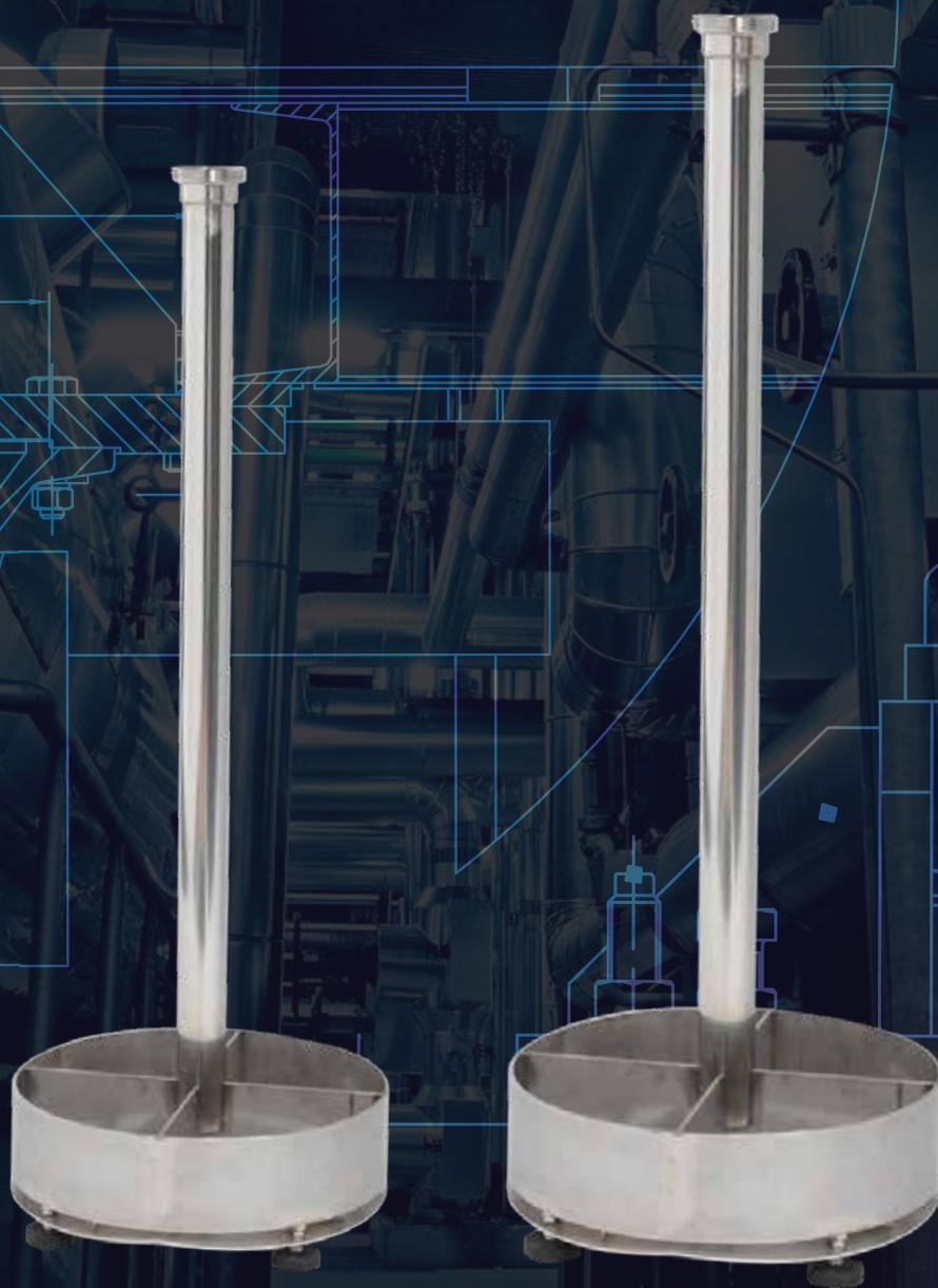
**Sistema che permette di diffondere omogeneamente il mosto flottato in tutta la vasca e in tutti i tipi di vasche**, indipendentemente dalla pesantezza delle fecce e dalla disposizione delle valvole di aspirazione e mandata. Composto da tubo convogliatore e piattello con apposite scanalature atte a diffondere il mosto a 360° nella vasca e ad ottimizzare la formazione del cappello. **Facilita anche le operazioni di pulizia del fondo a fine flottazione per rimuovere i residui di feccia.**
