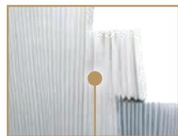
Os elementos filtrantes são fluxados com água ultrapura e depois desidratados com ar quente esterilizado.
